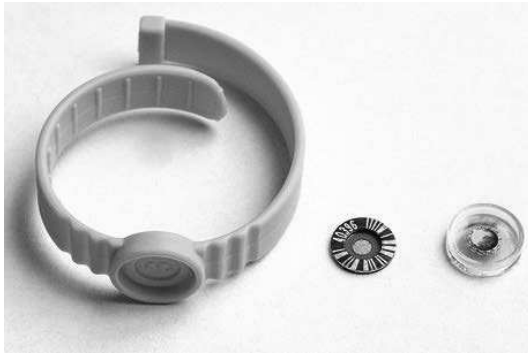
Bild 8.24 Fingerringdosimeter für Photonen- und Betastrahlung: Einweg-Plastikringkörper; Detektorelement, TLD: ^7\text{LiF} : Mg, Cu, P; Dicke: 5 \text{ mg/cm}^2 ; Abdeckung: 3,3 \text{ mg/cm}^2 (Bildquelle: MPA NRW)
