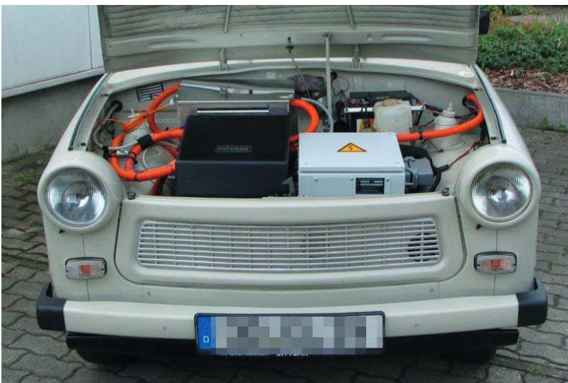
Abb. 19: Umgerüsteter Trabant auf Elektroantrieb. Foto: Matthias Bähr Quelle: elektromobilität-dresden.de
