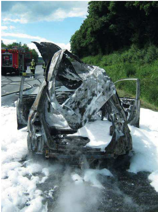
Abb. 16: Aufgerissener LPG-Tank nach Brandeinwirkung. (Quelle: Feuerwehr Warburg)
